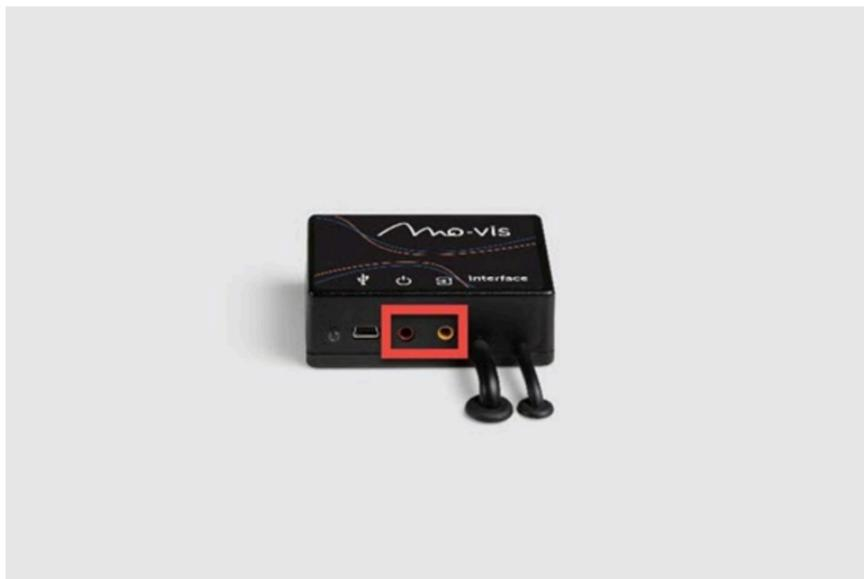
Sie können an den Joystick ein oder zwei Schalter anschließen:
