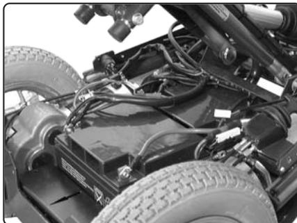
*Fig. 5 Batteries*
